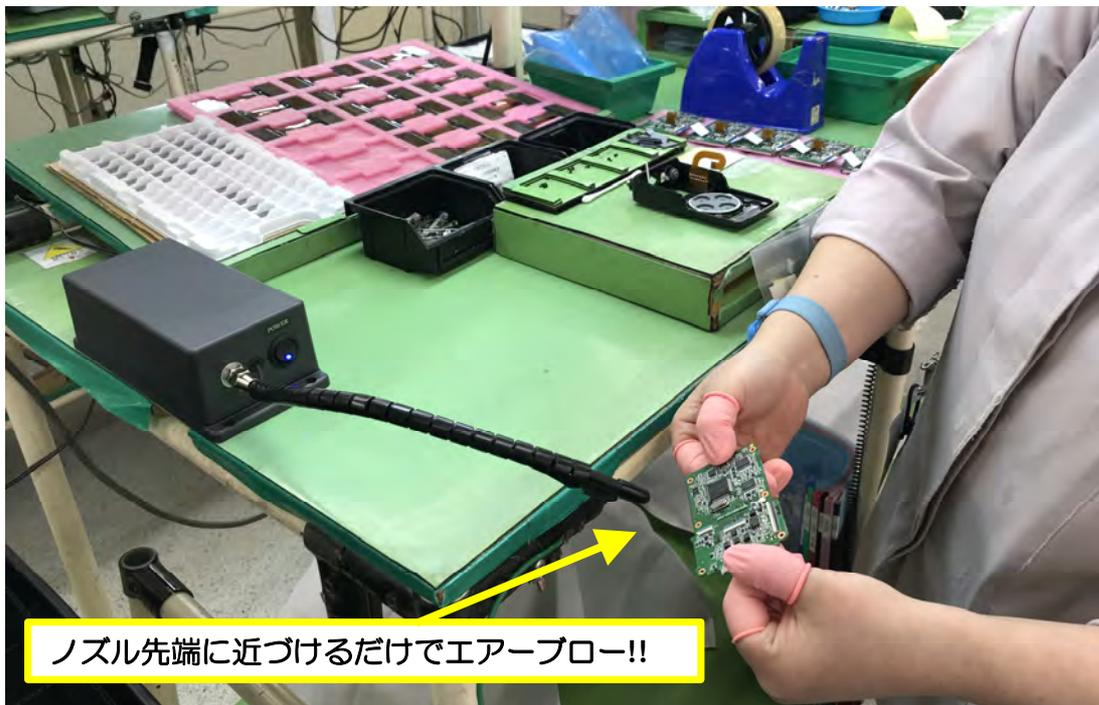
作業台への設置例（標準 ホース&ノズル）
